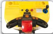
Horómetro, indicador de descarga de batería y botón de paro.
