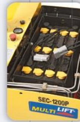
Batería industrial de 24 Volts de ciclo profundo. Sistema de intercambio lateral.
