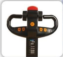
Palanca ergonómica con botón de emergencia.
