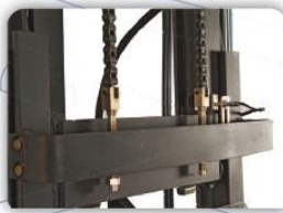
Microswitches magnéticos que minimizan fallas mecánicas y eléctricas.
