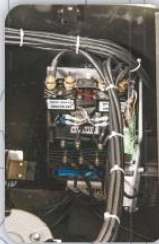
Controlador CURTIS que suaviza los movimientos y optimiza la operación.
