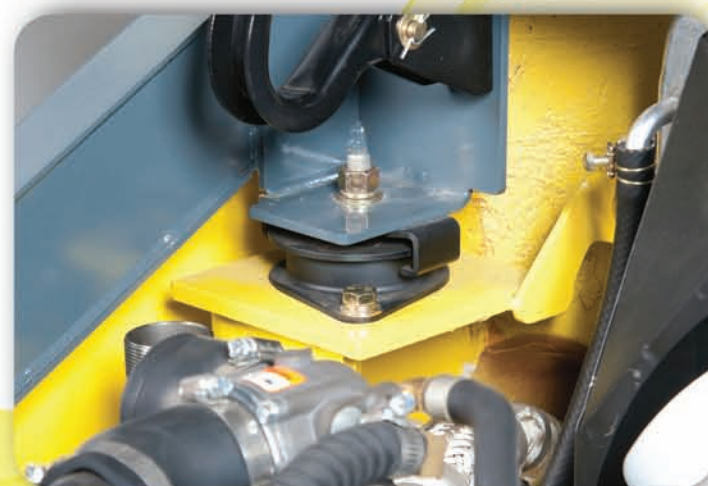
Cabina flotante con amortiguadores que disminuyen la vibración y aumentan el confort
